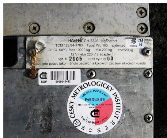
Obr. 3 Ověření a plomba na váhách
