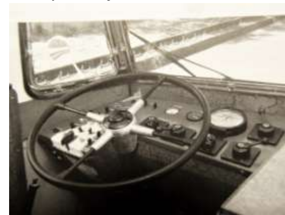
Typické stanoviště řidiče u trolejbusu Tatra T 400
